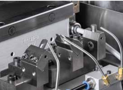
3-Punkt Profilabrichter G3 mit Geradeabrichter
