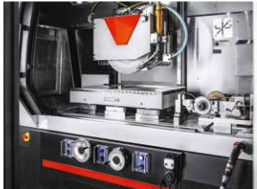
Nullpunkt-Spannsystem mit Magnet
