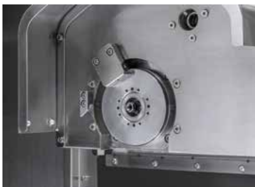
Spindel mit automatischer Spann- und Entspannfunktion
