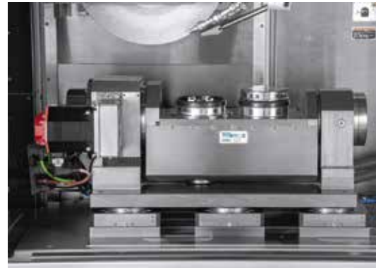
Nullpunkt-Spannsystem mit Teilapparat
