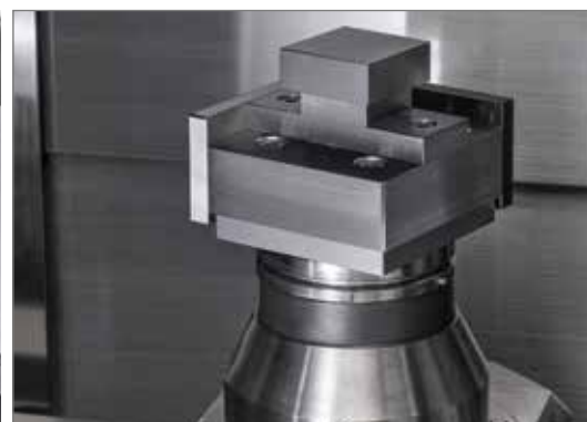
Teilapparat für 5-Seitenbearbeitung
